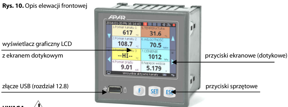
Rys. 10. Opis elewacji frontowej
